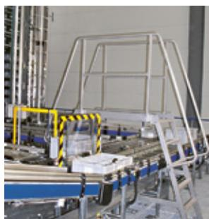
3 Passerelle au-dessus d'un transporteur à rouleaux
