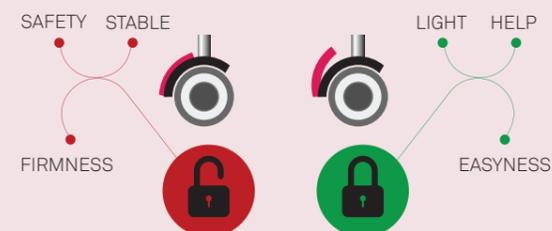
Les roulettes freinantes avec dispositif de blocage permettent à l'opérateur de transférer le patient du lit au fauteuil avec la certitude que ce dernier ne glisse pas.
